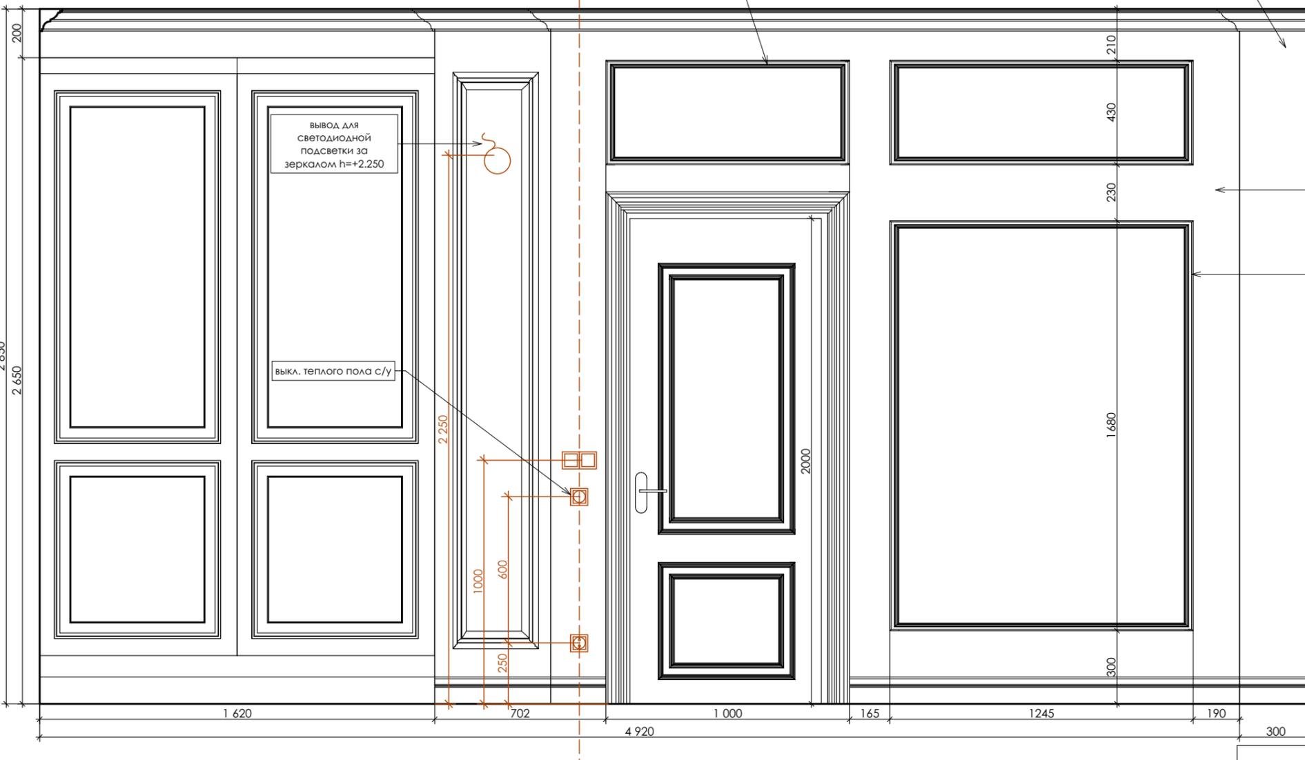
За отметку 0,000 принята высота чистого пола квартиры
