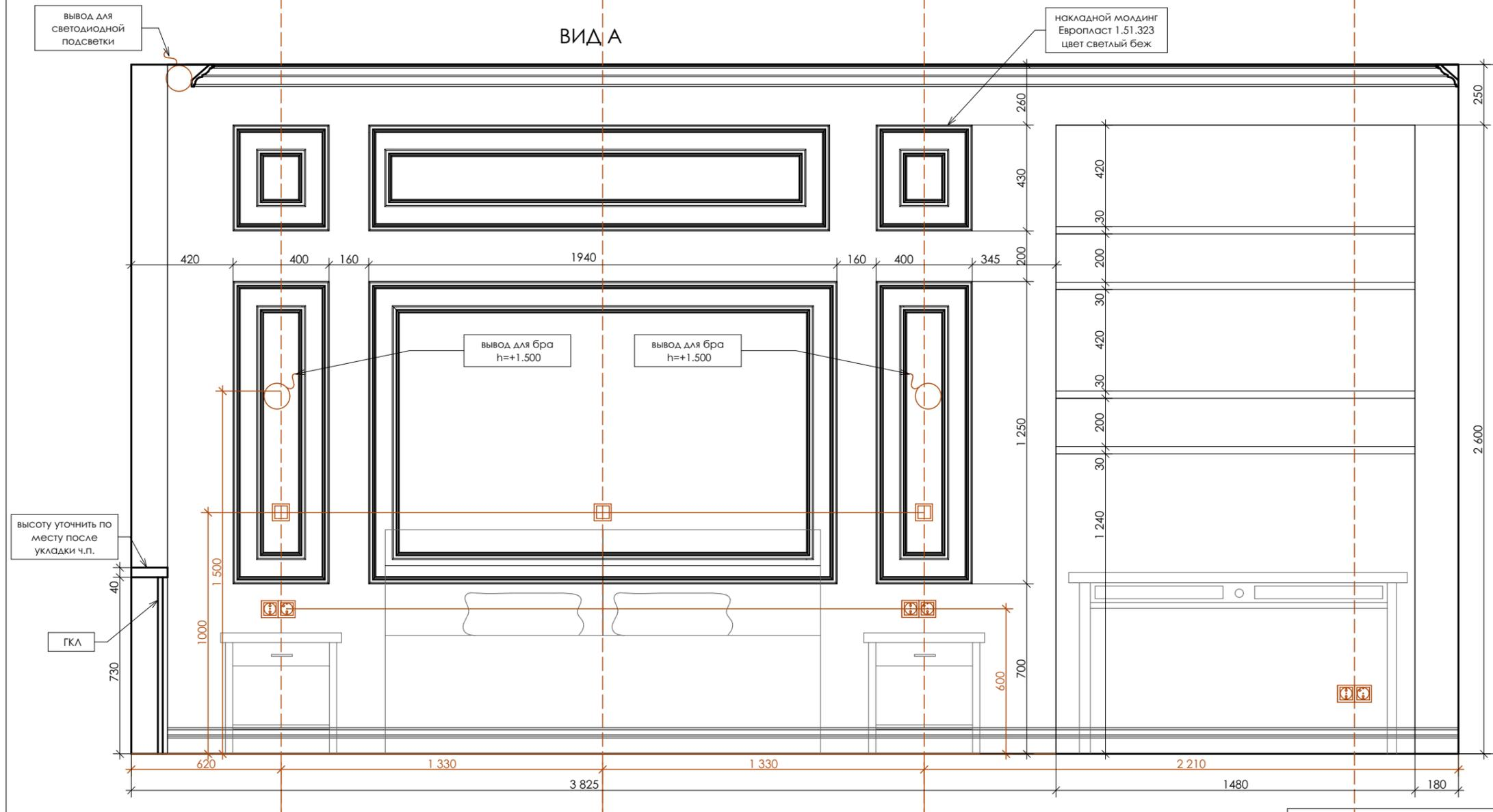
За отметку 0,000 принята высота чистого пола квартиры
